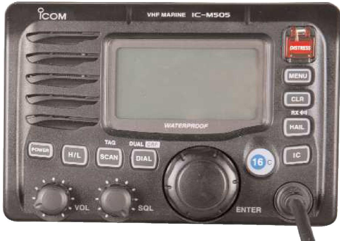
Im Gegensatz zum IC-M503 ist beim IC-M505 der DSC-Controller in das Funkgerät integriert. Die Funktionen der Tasten entsprechen größtenteils denen des DS-100 bzw. IC-M503. Folgende Unterschiede sind jedoch zu beachten:
